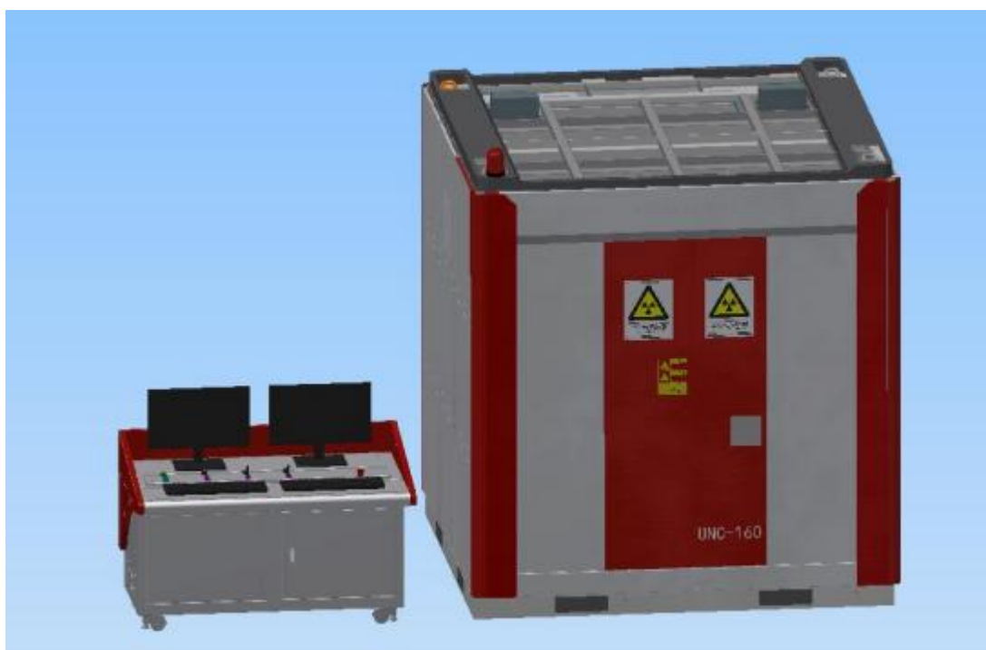
图 9-4 本项目 UND160 型 X 射线探伤装置外部实例图示
